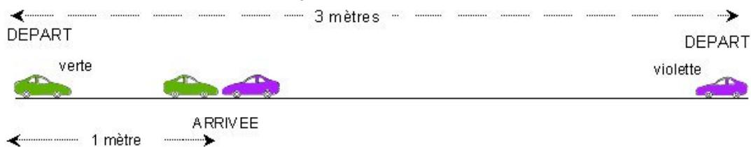
Les deux voitures démarrent au même moment. Elles se rencontrent à une distance d'un mètre de l'extrémité gauche du rail, et s'arrêtent après une seconde ( $t_{\text{arrivée}} = 1\text{s}$ ).
