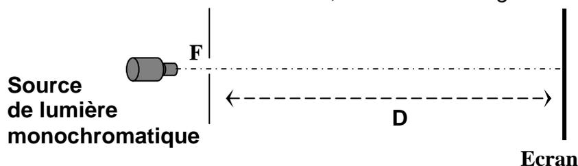
Sur l'écran, on observe, dans la direction perpendiculaire à la fente, une tache lumineuse centrale de largeur  $L$  nettement supérieure à la largeur  $a$  de la fente ainsi qu'une série de taches lumineuses plus petites de part et d'autre de la tache centrale :
