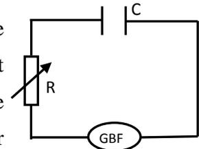
On fixe  $R$  à la valeur  $100\Omega$  grâce à un oscilloscope bicourbe on visualise simultanément les deux tensions  $u(t)$  et  $u_C(t)$ . Pour une valeur  $N_1$  de la fréquence du GBF, on observe les deux courbes
