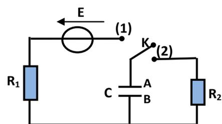
A un instant que l'on choisit comme origine des temps, on place  $K$  sur la position (1) et on suit l'évolution au cours du temps de la tension  $u_{R_1}$  aux bornes du résistor  $R_1$  sur la voie  $Y_1$  d'un oscilloscope à mémoire.
