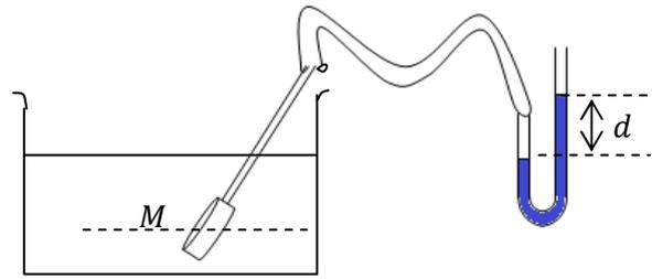
★ On observe une.....du liquide coloré dans le manomètre quand la capsule est au point  $M$ .
