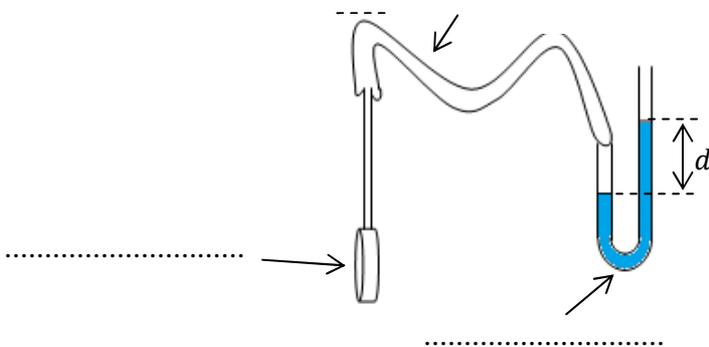
↳ La capsule manométrique (manoscope) est un capteur de pression.
