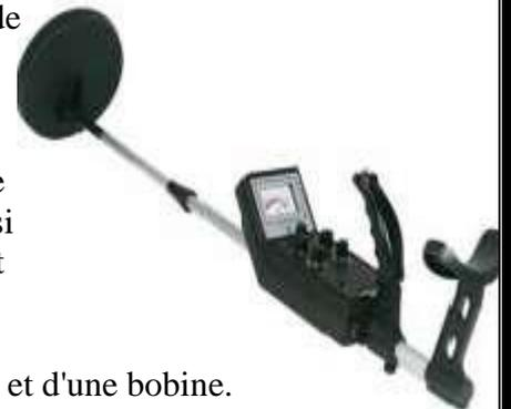
Le détecteur est équivalent à un oscillateur constitué d'un condensateur et d'une bobine.
