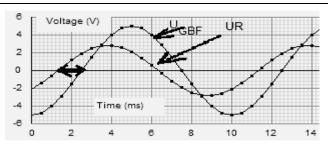
Les deux tensions  $U_R$   $U_{GBF}$  oscillent sinusoïdalement et périodiquement , la tension  $U_R$  varie avec la même fréquence et donc la même que celle délivré par le GBF pour cette raison on parle <u>d'oscillations électriques</u> <u>forcées</u> , bien que le GBF impose sa propre fréquence sur le résonateur ( le circuit RLC) On remarque aussi que la tension  $U_R$  est en avance de phase par rapport à la tension  $U_{GBF}$
