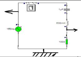
On fait modifier la fréquence de GBF, on remarque toujours que les tensions U<sub>GBF</sub> et U<sub>R</sub> oscillent avec les mêmes fréquences (c'est-àdire 150 Hz) alors on observe que le décalage de temps diminue et bien sûr le déphasage diminue aussi
