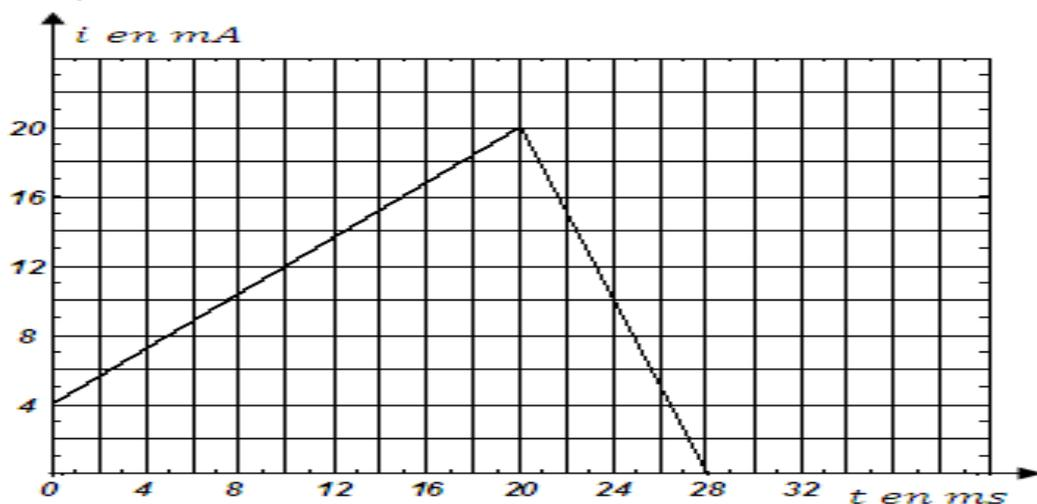
a- Déterminer les expressions de l'intensité  $i$  du courant électrique dans les intervalles de temps  $[0 ; 20\text{ms}]$  et  $[20\text{ms} ; 28\text{ms}]$ .
