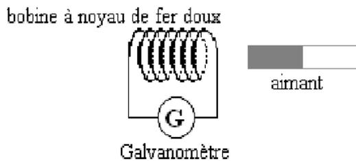
Quand on approche l'aimant de la bobine le long de l'axe, l'aiguille du galvanomètre dévie. Dès que l'aimant est immobile, l'aiguille revient à zéro. Lorsqu'on éloigne l'aimant, l'aiguille dévie en sens inverse.
