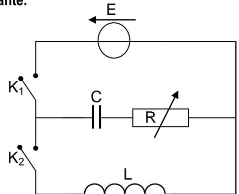
1) Compléter le schéma du montage de la figure 4 (page 5/5, à rendre avec la copie) en indiquant les connexions à réaliser avec l'oscilloscope afin de visualiser, sur sa voie (X), la tension  $E$  et sur sa voie (Y), la tension  $u_C$ .
