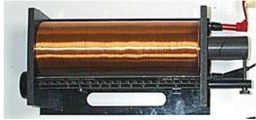
Une bobine est constituée d'un enroulement serré de fil conducteur enrobé d'un matériau isolant. Ce fil conducteur présente le plus souvent une résistance  $r$  de faible valeur.
