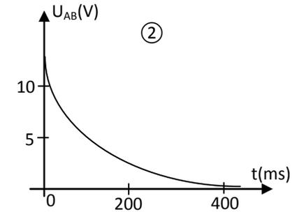
Lorsque l'interrupteur est en position 1, le condensateur est chargé à travers un résistor de résistance  $R'$ , à l'aide d'un générateur  $G$  de tension continue de f.e.m  $E = 12 \text{ V}$ . A l'instant  $t = 0 \text{ s}$ , le condensateur étant complètement chargé, on bascule l'interrupteur en position 2 : le condensateur se décharge dans le résistor de résistance  $R = 500 \Omega$ .
