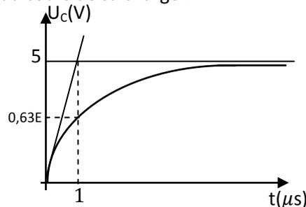
Le circuit réalisé comprend en série le condensateur, un résistor de résistance  $R = 100 \Omega$ , un interrupteur  $K$  et générateur de tension continue de f.e.m  $E = 5 \text{ V}$
