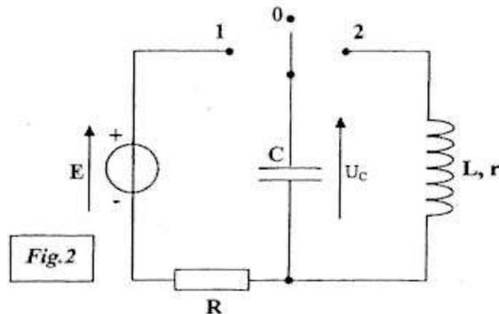
Le circuit de charge (**Figure.2**), outre le condensateur de capacité  $C$ , est constitué d'un conducteur ohmique de résistance  $R$  et d'un générateur idéal de tension de force électromotrice  $E = 8 \text{ V}$ .
