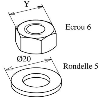
**2-8-** Recherchez à l'aide du livre le type de la rondelle (5), (S, N, L), si la vis (4) a un diamètre de 10 et la rondelle un diamètre extérieur de 20 :
