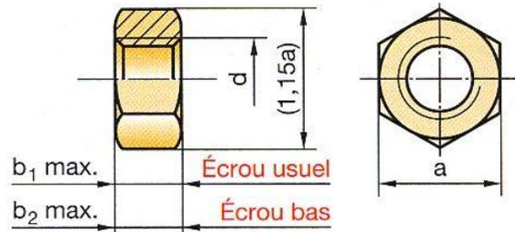
La dimension a donne la dimension de la clé nécessaire au serrage d'un écrou hexagonal
