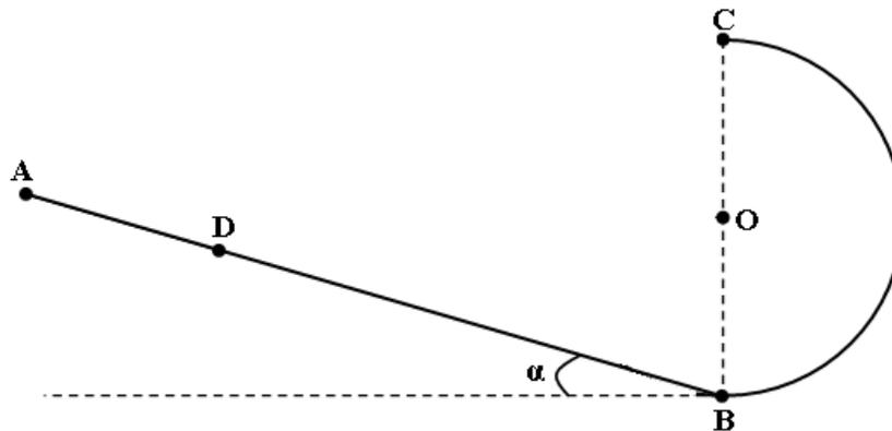
On donne :  $AB = 5 \text{ m}$  ;  $r = OC = OB = 0,5 \text{ m}$  ;  $\alpha = 15^\circ$  ;  $\|\vec{V}_B\| = 3 \text{ m.s}^{-1}$  et  $\|\vec{g}\| = 9,8 \text{ m.s}^{-2}$ .
