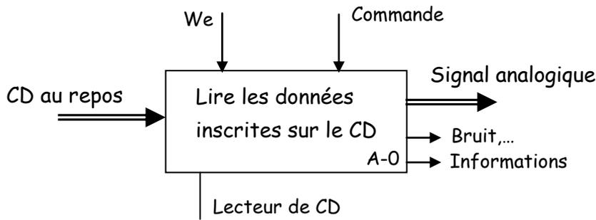
1°) En se basant sur le modèle fonctionnel niveau A-0 ci-dessus et aux termes ci-dessous, compléter l'actigramme de niveau A0 simplifié du lecteur de CD. (2.75 Pts)
