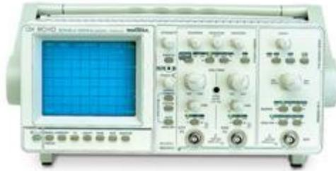
On règle l'oscilloscope de manière à faire apparaître au centre de l'écran un segment lumineux horizontal sur la voie X (fig ❶).
