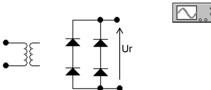
b - Tracer l'allure de la tension  $U_r$  à l'échelle : ( 2 pts )
