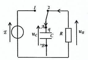
✓ En l'absence de générateur dans le circuit, les électrons accumulés sur l'armature négative B lors de la charge du condensateur, se déplacent vers l'armature positive A par l'intermédiaire des fils de connexion. Un courant apparait alors dans le circuit, et la valeur des charges électriques accumulées sur les armatures du condensateur diminue : il se décharge.
