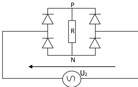
6/ Représenter sur le schéma du circuit le sens du courant débité par le secondaire au cours de chaque alternance avec deux couleurs différentes. (1 pt)
