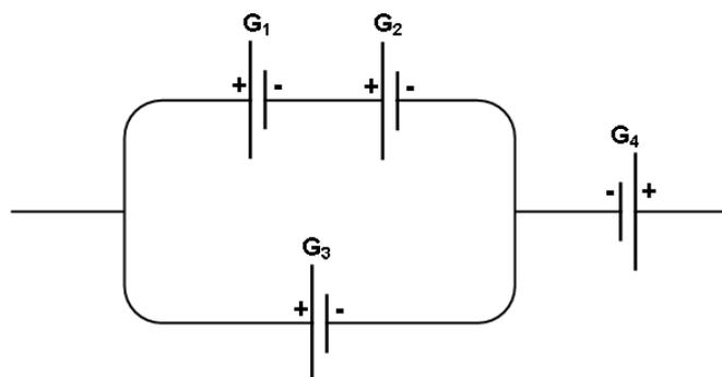
➤ Trouver la fem  $E$  et la résistance équivalente  $r$  du générateur  $G$  équivalent.
