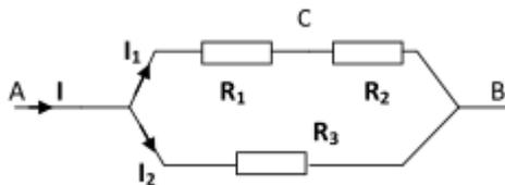
avec  $R_1 = R_3 = 40 \Omega$  et  $R_2$  inconnue.
